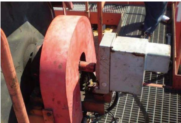
Mechanisches Kopierwerk zur Positionsüberwachung am Hubwerk eines RTG-Krans.
