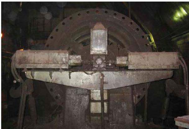
*Vorher: Alte Skip-Car-Steuerung mit zwei mechanischen Getriebe-Nockenschaltwerken.*
