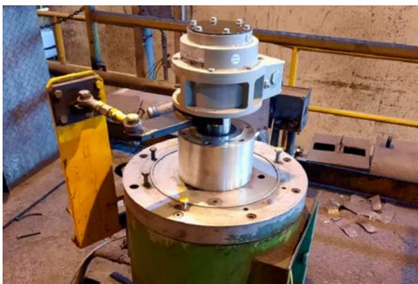
Nachher: Der Hohlwellen-Absolutwert-Drehgeber ASSH 60 K-16/50P mit Drehmomentstütze (direkt angebaut)
