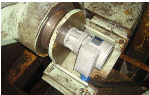
Looper-Drehgeber mit Heavy-Duty-Kugellagern und Spezialschmierung für lange Lebensdauer.
