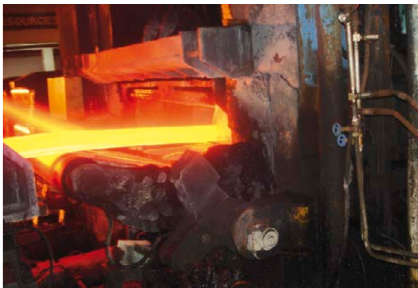
Schlingenheber (Looper) sind im Warmwalzwerk extremen Umgebungsbedingungen ausgesetzt.
