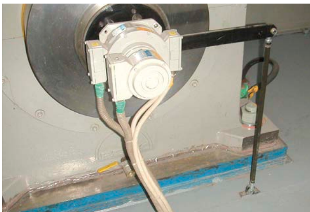
Elektronischer Grenzdrehzahlswitcher EGS 41 als Anbaugerät am inkrementalen Drehgeber FGH 6.
