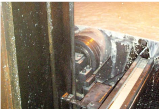
Sensoren zur Ermittlung der Bandgeschwindigkeit sind im Bereich der Zugmessrolle extremen Umgebungsbedingungen ausgesetzt.
