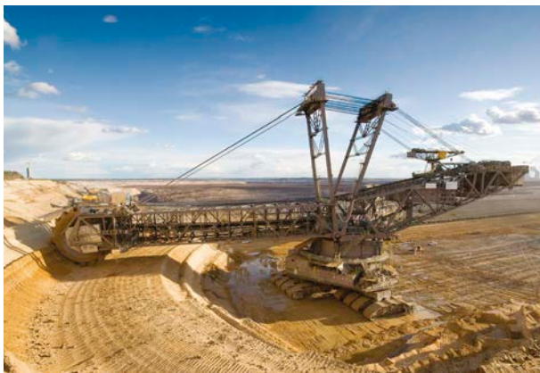
Der Baggerführerstand befindet sich am Schaufelradbagger am Ende des Auslegers.
