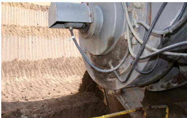
Mit dem hochauflösenden Drehgeber FG 40 lassen sich selbst kleinste Drehzahländerungen sehr schnell erfassen.
