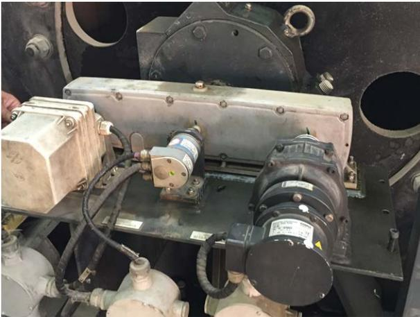
Vorher: Verteilergetriebe mit mechanischem Kopierwerk, Absolutwert-Drehgeber und mechanischem Fliehkraftschalter
